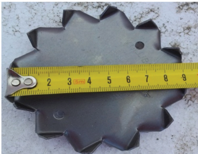
Рис. 5. Виды и размеры коннекторов для крепления EPS-блоков в насыпи
